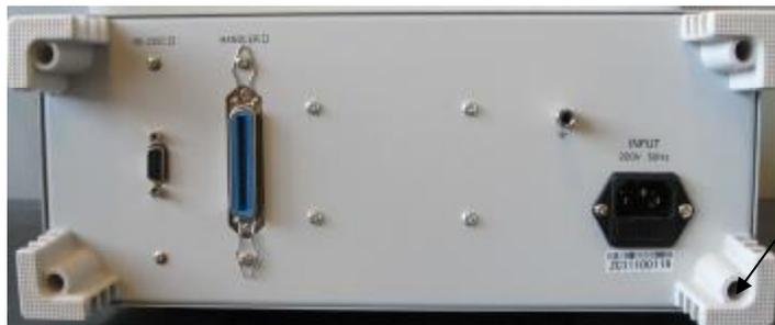
Рисунок 2 – Вид задней панели измерителя иммитанса
