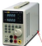
Рисунок 2 – Схема пломбировки от несанкционированного доступа.
