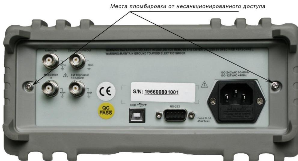
Рисунок 2 – Схема пломбировки от несанкционированного доступа и место нанесения серийного номера, идентифицирующего каждый экземпляр СИ
