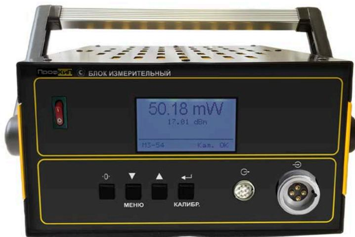
Рисунок 3 – Расположение органов управления и присоединения БИ на передней панели
