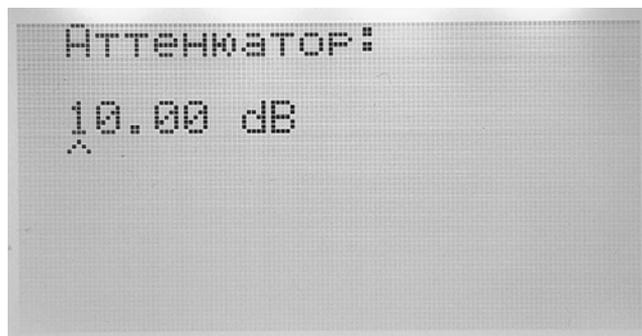
Рисунок 7 – Ввод значения аттенюатора
