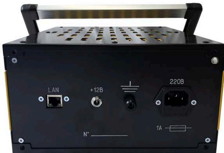
Рисунок 4 – Расположение органов управления и присоединения БИ на задней панели
