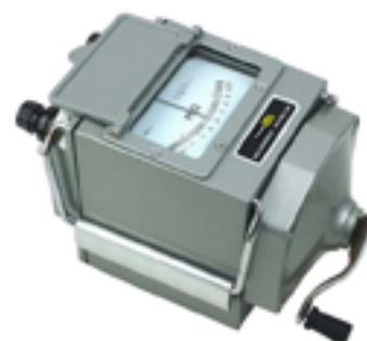
**ПрофКиП М4100/2М мегаомметр**
