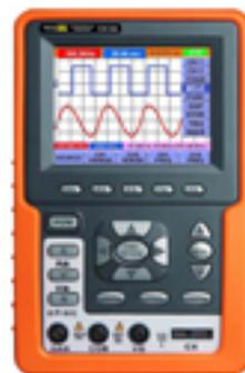
**ПрофКип С8-192 осциллограф-мультиметр портативный**
